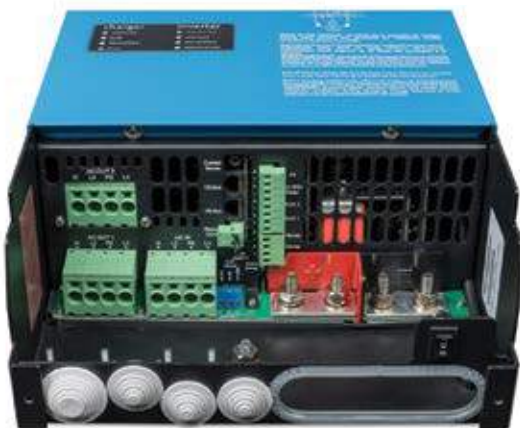
Zona de conexión
